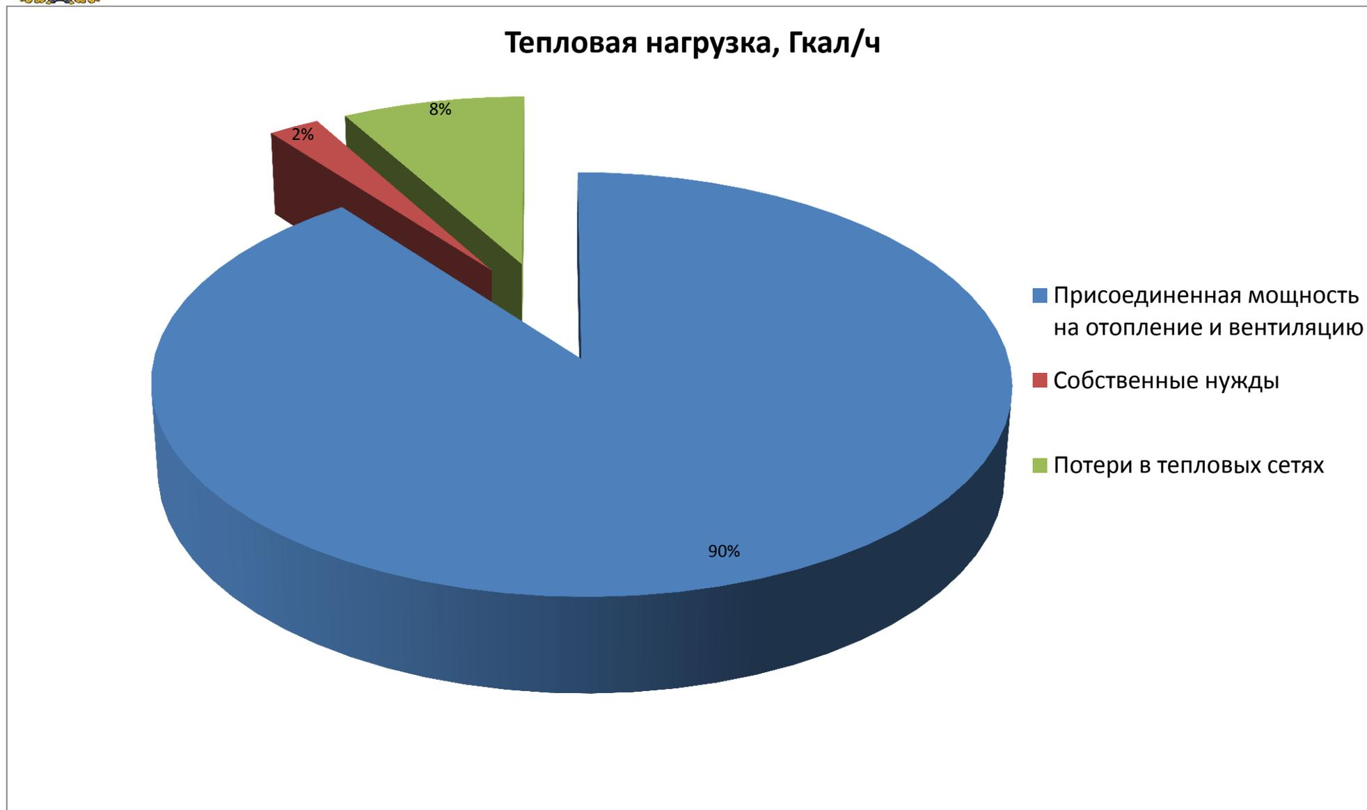
Рис. 1.2. Соотношение нагрузок отопления, вентиляции и расчетных потерь тепла в системах теплоснабжения сельского поселения Износки от всех источников теплоты
