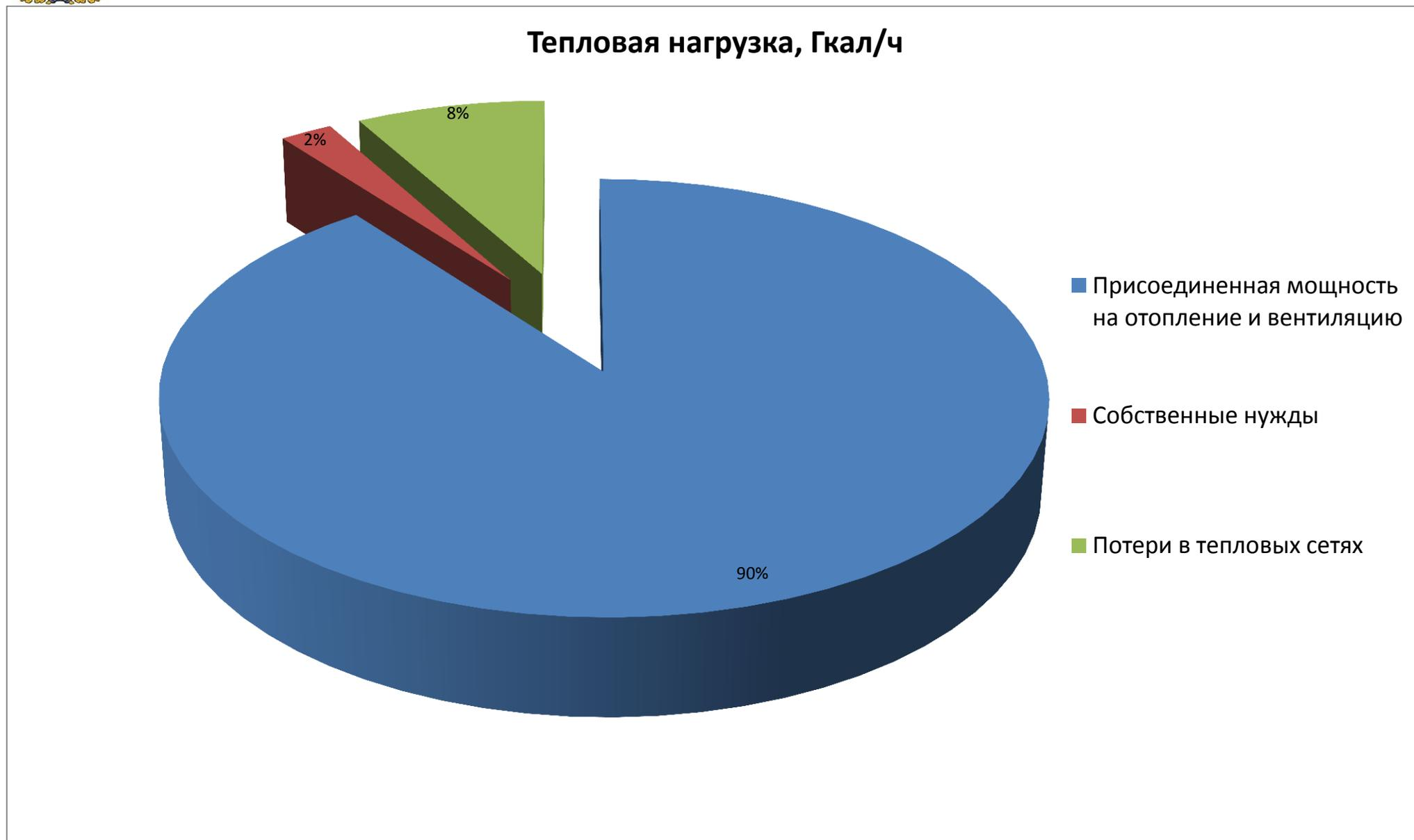
Рис. 1.4. Структура выработки тепловой энергии котельной №2 Школа
